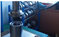
Montage roulement par segment
